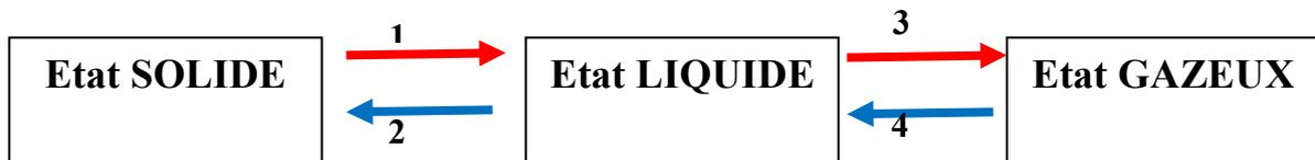
1 : FUSION 2 : SOLIDIFICATION 3 : VAPORISATION 4 : LIQUEFACTION ou CONDENSATION
