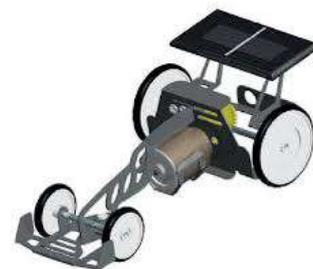
Lorsque la cellule est éclairée par la lumière du Soleil, elle alimente un petit moteur électrique. Les roues de la voiture-jouet tournent et celle-ci se met en mouvement.
